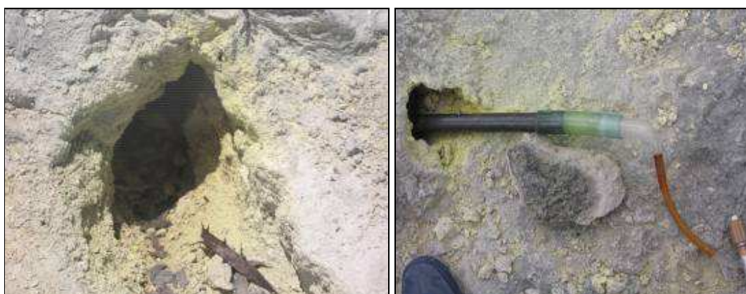
Figura 2.3.26. Imágenes de la toma de muestra de gases en la fumarola Mallama del Volcán Azufral.
