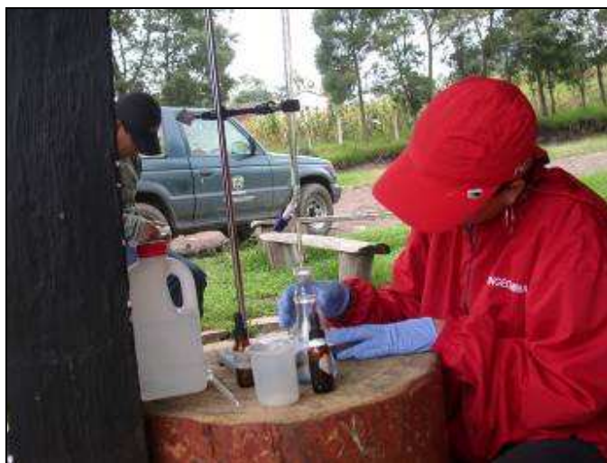
Figura 2.1.79. Fotografía del análisis de carbonatos y bicarbonatos de las fuentes termales del Volcán Galeras.
