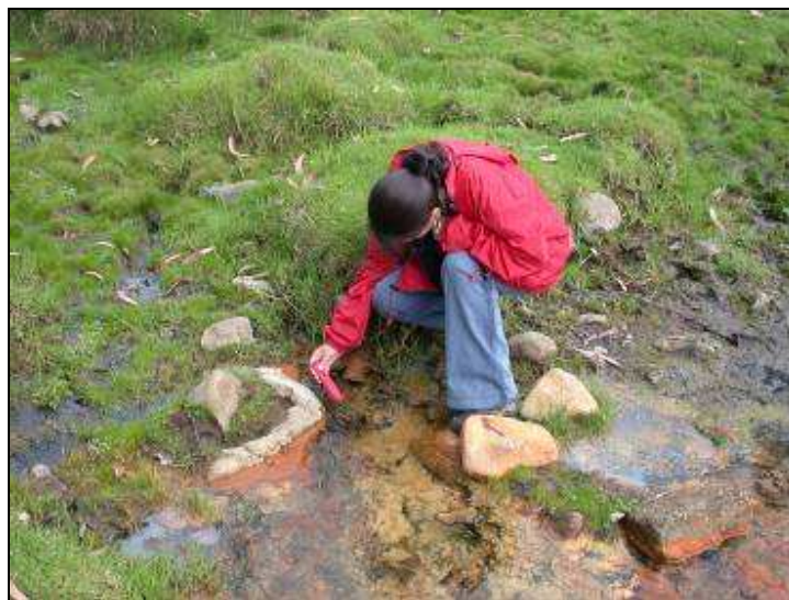
Figura 2.4.10. Fotografía de la medición de pH en la Fuente termal el Salado, del Volcán Cumbal.
