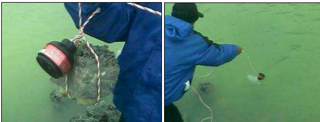
Figura 2.3.28. Fotografía de la instalación de la estación de gas Radón en el agua, de la Laguna Verde del Volcán Azufreal.
