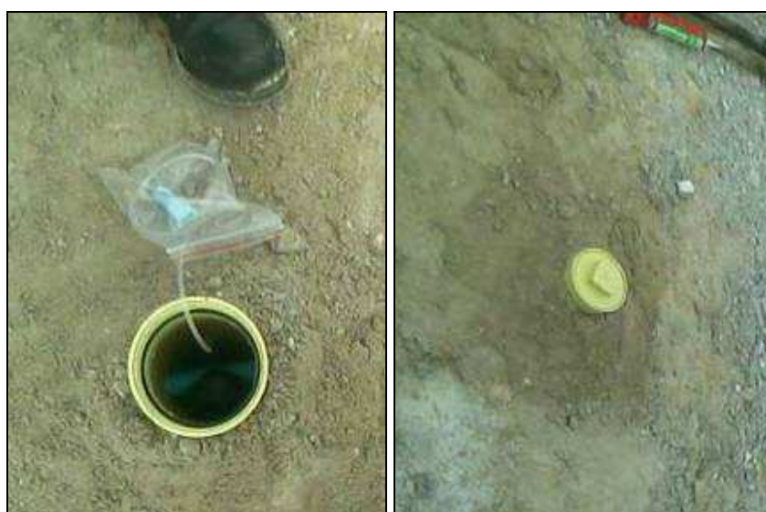
Figura 2.3.27. Fotografía de la instalación de la estación de gas Radón en el Volcán Azufral.
